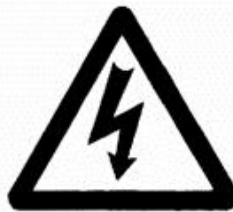
Farlig elektrisk spænding
